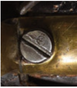
Märkt på skruven som går genom varbygelns som håller fast svansskruven
