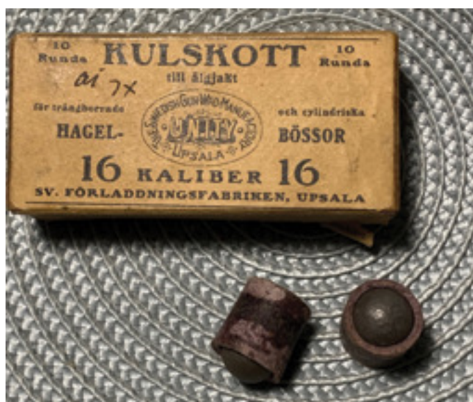
Underkalibrerad rundkula i filtförladdning för slätborrat vapen kaliber 16. Kulans diameter är 14,2 mm. Ursprungligen var den avsedd för en drivladdning av svartkrut.
