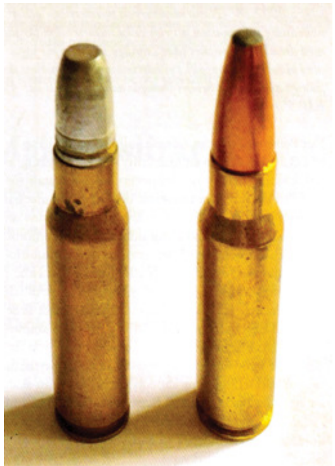
Två patroner i kaliber .308 Winchester men med två helt olika kulor. Till höger en expanderande kula = klass 1 och till vänster en icke-expanderande homogen blykula = klass 3. Testresultat hjälper vapenägare att välja rätt.
