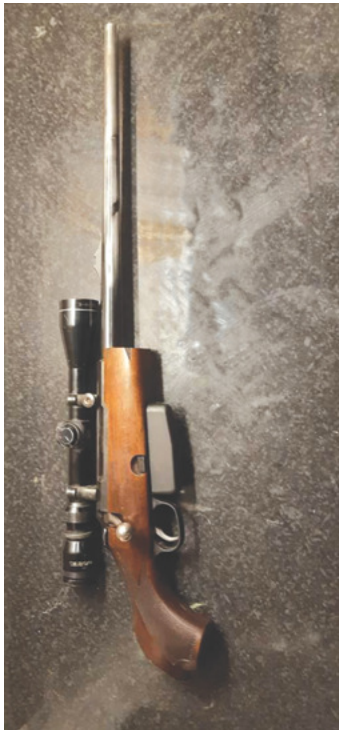
Ett gevär Tikka 690 i kaliber 6,5x55 konverterat till en pistol för metallsilhuetskytte. Tanken var god men vapnet blev inte den framgång som vapenägaren hade hoppats på och blev därför skrotat.
